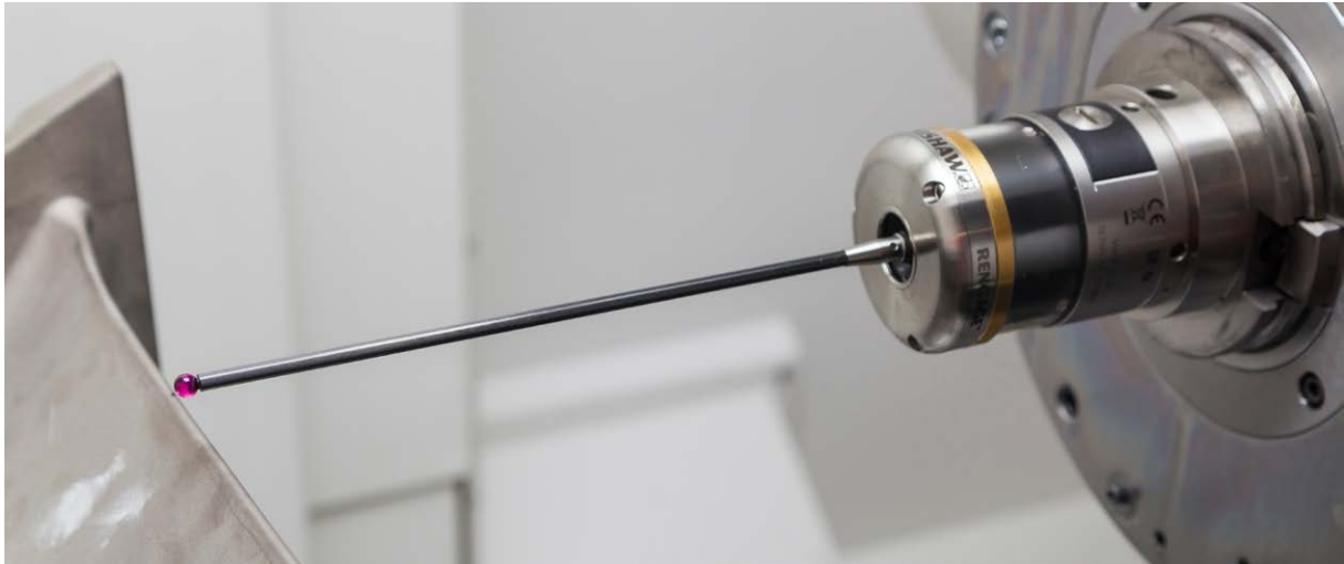
RMP600 Messtaster ermittelt die Position eines Schaufelblattes
