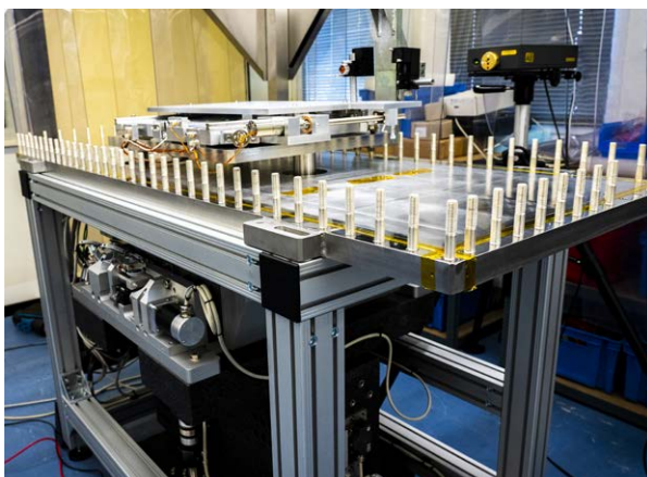
具備非真空和真空運動平台的反射鏡工作台
