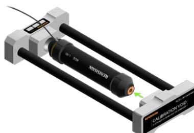
3. 拆卸时，必须将该过程颠倒过来操作。从校准装置上取下之前，通过缩回“无电缆端”关闭设备。
