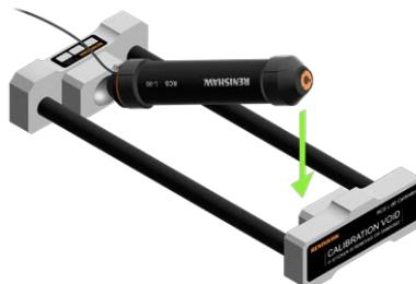
2. 延长设备，使伸缩支撑杆的另一端到达校准装置的另一端球面。确保以磁吸方式将RCS L-90伸缩支撑杆连接至校准装置。
